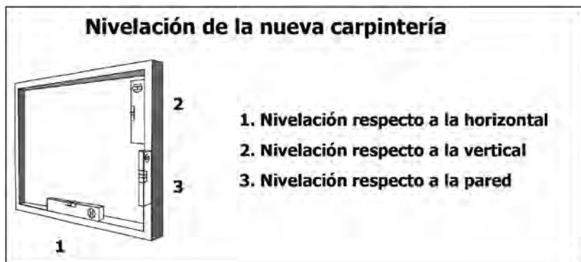
Figura 14. Nivelación de la nueva carpintería
