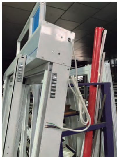
Figura 72. Salida del cableado del motor
